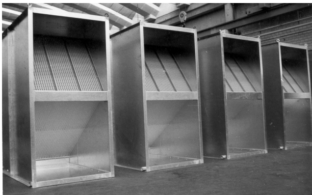
Varmevekslere til Køge Sygehus
